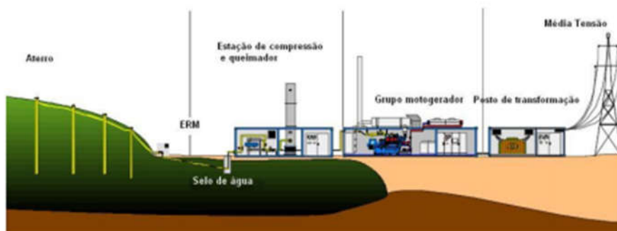
Ilustração 2 – Captação do metano em aterros sanitários.
